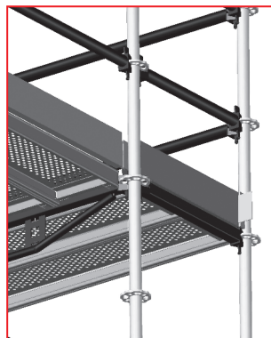
Rys. 3.24 – Narożnik wykonany za pomocą dwóch stojaków
