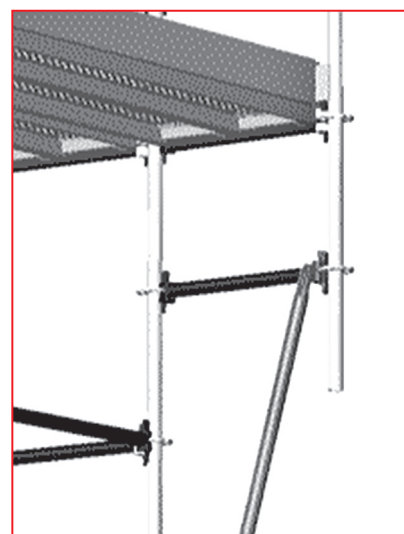
Rys. 3.29 – Rozszerzenie za pomocą rygli i stężeń
