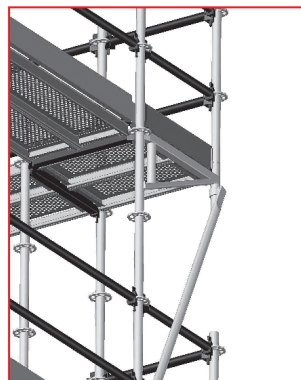
Rys. 3.25 – Narożnik wykonany za pomocą trzech stojaków, wspornika i stężenia (patrz rys. 3.28)
