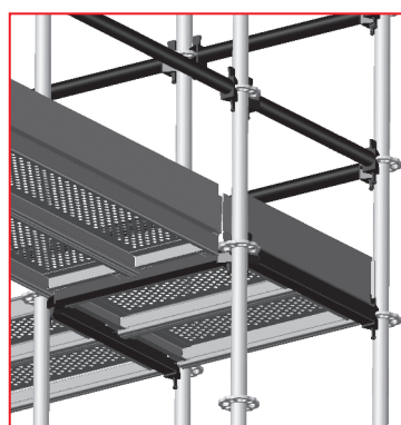
Rys. 3.26 – Narożnik wykonany za pomocą czterech stojaków
