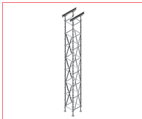
Rys. 3.64 – Rusztowanie ROTAX Plus w ustawieniu wieżowym
