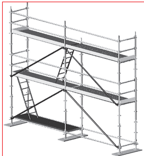
Rys. 3.23 – Przykład rusztowania z zabezpieczeniem bocznym
