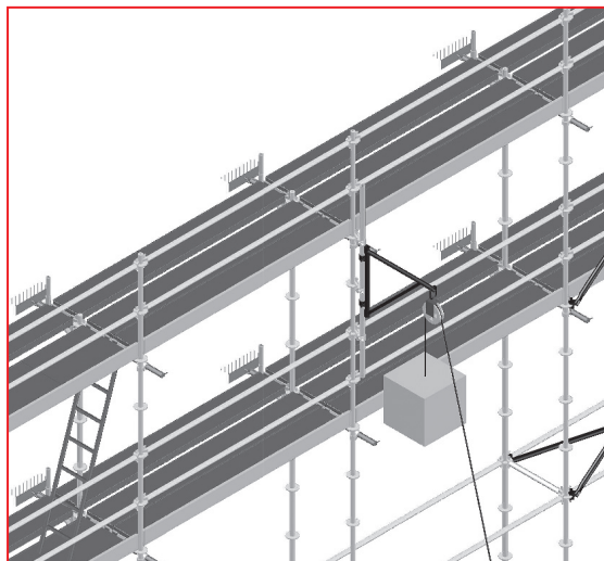
Rys. 3.79 – Rusztowanie z wciągarką
